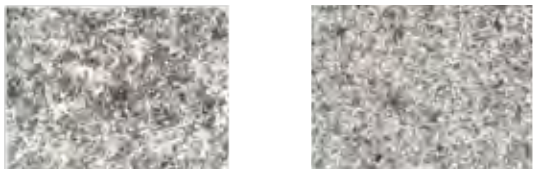
Outra marca: Mais de Troostite (Zn, Mn) elemento trará ponto fraco. (não é bom)
