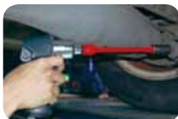
Como usar a Barra extensível p/ torque
