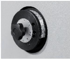
▶ **Controlo MA standard,** ajuste manual do ângulo de flexão através da escala de escala de anel na lateral da máquina
