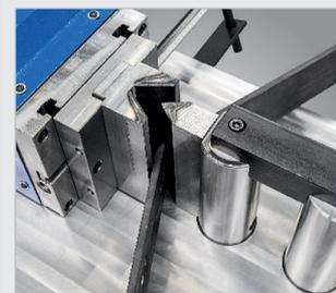
▶ Com montagem de abertura rápida e travão lateral com escala
