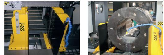
► Fixação a montante e a jusante do corte através de prensa de duas partes
