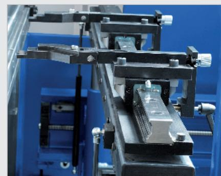
► Sistema de batente traseiro com eixo R (standard para séries S e Servo)
