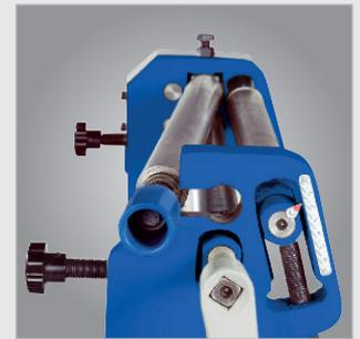
▶ O rolo superior pode ser girado para facilitar a remoção da peça acabada
