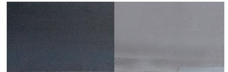
▶ Fig. Aço inox esquerda cru, direita lixada com MBSM 2505 ESE, usada a cinta lixa K 120 para estruturação da superfície
