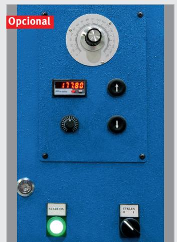
► **Controlo opcional PUD com display digital**, ajuste manual do ângulo de flexão e batente traseiro motorizado e ajustável
