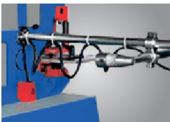
▶ Travão de contacto elétrico (standard a partir da HPS 55DS)
