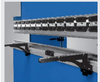
▶ Braços de suporte ajustáveis lateralmente com 2 posições de fixação
