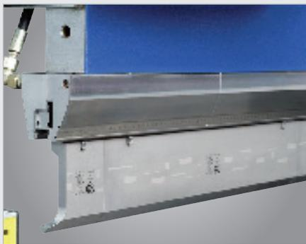
► Fixação da ferramenta superior hidráulica "WILA" para troca fácil de ferramentas em segundos (opcional)
