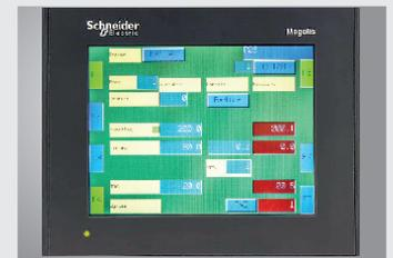
► **Controlo opcional Schneider CNC3A**, controlo de três eixos para entrada de ângulo digital e entrada da posição do batente traseiro e posição de abertura da barra com a opção de armazenar seqüências de flexão, batente traseiro motorizado com paragem de dedos, percurso 15-1000mm
