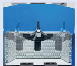
▶ Ajuste rápido do cilindro através de volante
