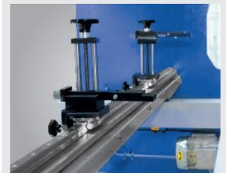
▶ Batente de dedos traseiro na guia linear ajustável lateralmente e regulável em altura através de fusos
