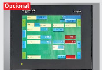
► **Controlo opcional Schneider CNC2A**, controlo de dois eixos para entrada de ângulo digital e entrada da posição do batente traseiro com a opção de armazenar sequências de flexão, batente traseiro motorizado com paragem de dedos, percurso 15-1000mm
