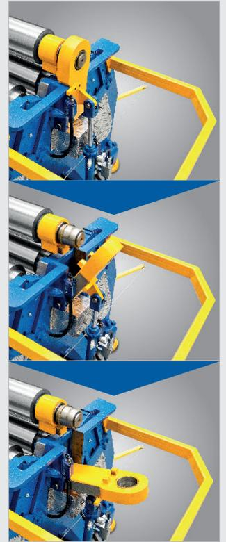
*Bucha de segurança hidráulica para fácil remoção de peças acabadas*
