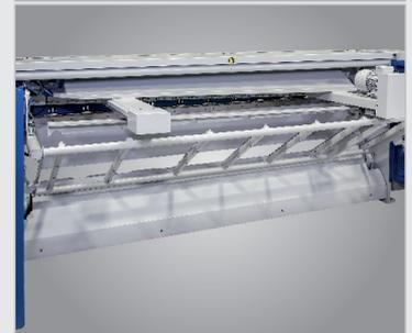
► Suporte de chapa pneumático com alavanca seletora para a direção da calha de chapa. O operador pode escolher se a secção cortada cai na traseira ou ao lado do operador
