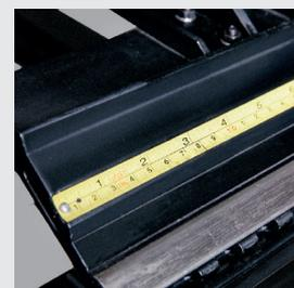
▶ Escala de comprimento 0 - 3200 mm em mm e polegadas
