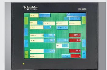
► **Controlo opcional Schneider CNC3A**, controlo de três eixos para entrada de ângulo digital e entrada da posição do batente traseiro e posição de abertura da barra com a opção de armazenar sequências de flexão, batente traseiro motorizado com paragem de dedos, percurso 15-1000mm
