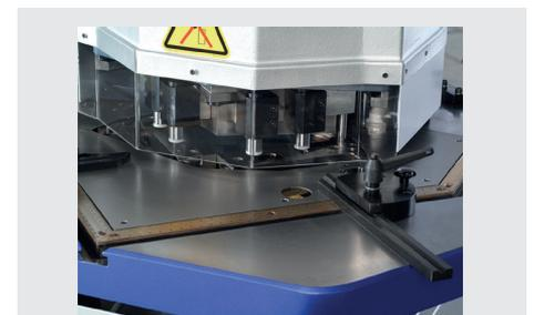
Mesa de trabalho com ranhuras em T e balanças recuadas. Fixador hidráulico
