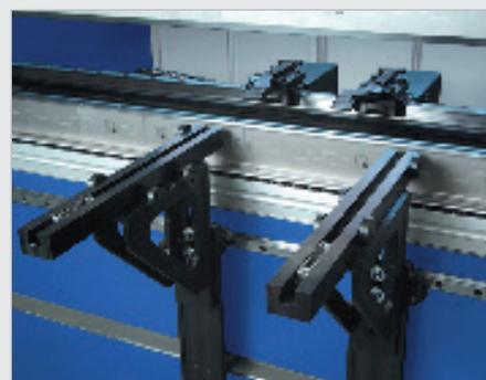
► Suportes frontais móveis (standard para R, S e Servo)
