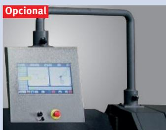
► **Controlo CNC opcional com gráficos 3D**, os perfis são feitos pelo operador num generoso ecã touch de 19"; Todas as posições dos eixos e a sequência de flexão são calculadas pelo controlo, batente traseiro motorizado com paragem de dedos, percurso 15-1 000 mm
