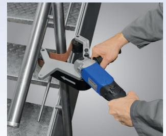
Particularmente indicado para corrimões já instalados
