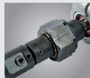
Engrenagem de inversão para curta duração de processamento: pressão no fuso inicia ação lenta no sentido dos ponteiros do relógio. Ao puxar ativa ação rápida.
