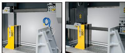
▶ O guia de fita frontal move-se automaticamente em paralelo com o torno móvel para uma orientação mais precisa da fita de serra
