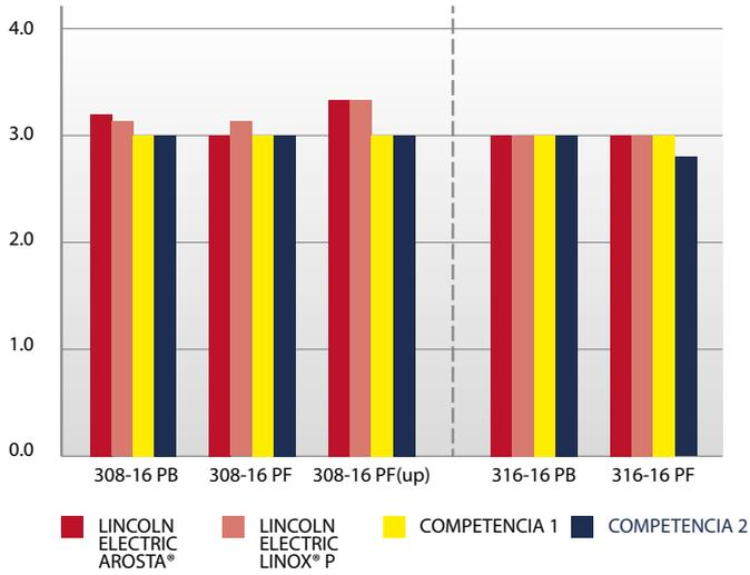
Ventaja de Lincoln Electric en soldadura en posición con estabilidad de arco y apariencia de cordón
