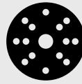
ø150mm com 15 furos de ø9mm num círculo de ø120mm; 6 furos de ø9mm num círculo de ø80mm + 1 furo central de ø17mm
