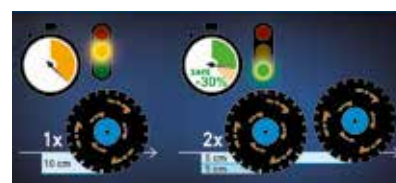
Indicador de profundidade de corte patenteado
