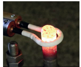
▶ Aquecimento de um parafuso roscado com a bobina refrigerada a água
