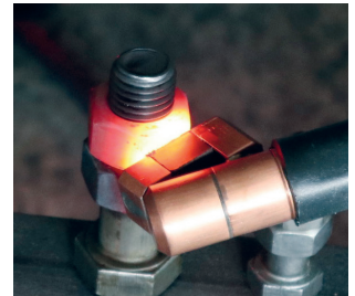
▶ Aquecimento de uma porca com bobina de foco em ângulo
