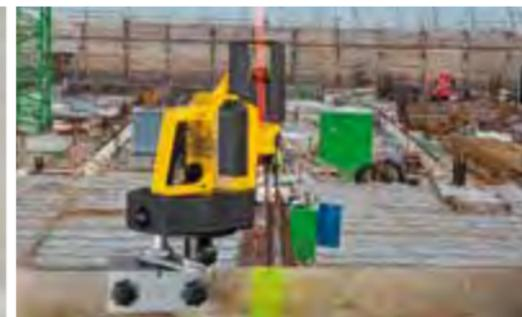
Transmitir eixos – da estrutura de fio-de-prumo para a placa base. Mediante pressão do botão, a linha de laser vertical é alinhada automaticamente até 40 m.
