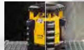
Proteção contra água e poeira conforme a classe de proteção IP 65
