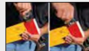
**Tipo 106 T:** Os distanciadores encaixam-se nas plaquinhas da superfície de medição superior. Girar uma vez – assento fixo.
