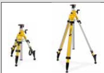
Tripé para a construção civil com coluna acionada por manivela, amortecimento pneumático, proteção contra extensão e dispositivo de fecho rápido. Pernas do tripé com pontas e capas rotativas de borracha dura, parafuso de rosca 5/8".
