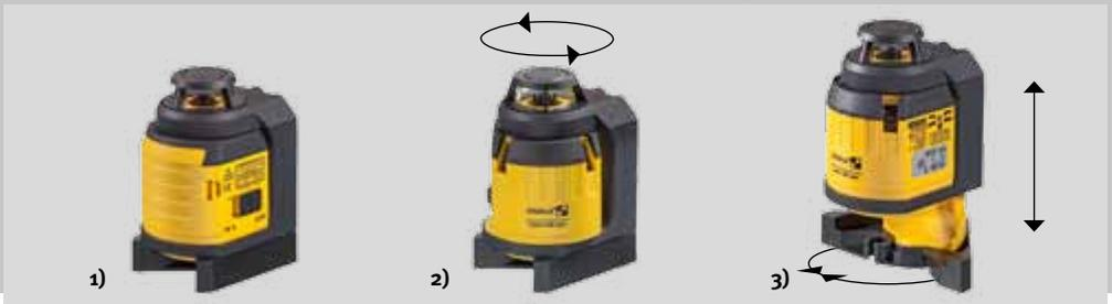
1) Posição de estacionamento. 2) A caixa roda a 360° graças à pega em U. 3) Ajuste do laser em altura graças ao pé amovível. A superfície de contacto permite o posicionamento do laser, p. ex., junto a perfis em U.
