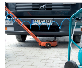
WWH 60000 PH Torreta de segurança simples de operar com ligação de ar comprimido
